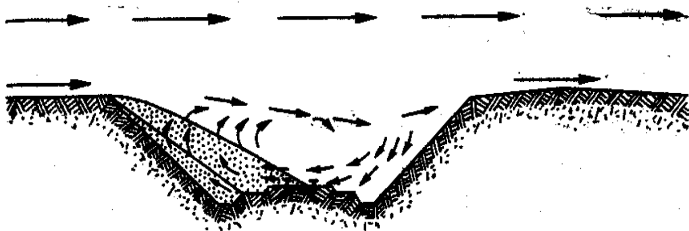
Рис. 13.4. Схема образования песчаных заносов в железнодорожной выемке в Каракумах (по М. П. Петрову)
